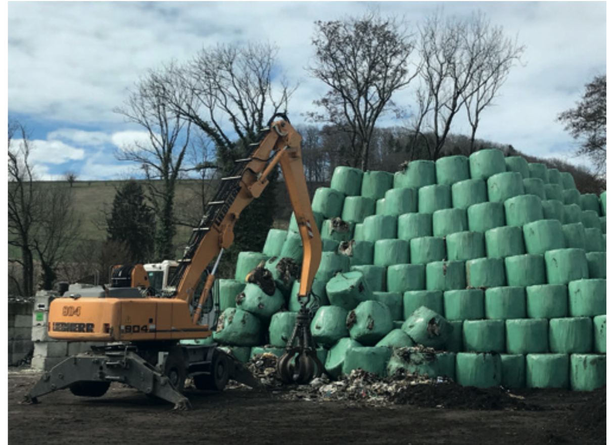
Chargement des déchets mis en balle en vue de leur valorisation thermique
