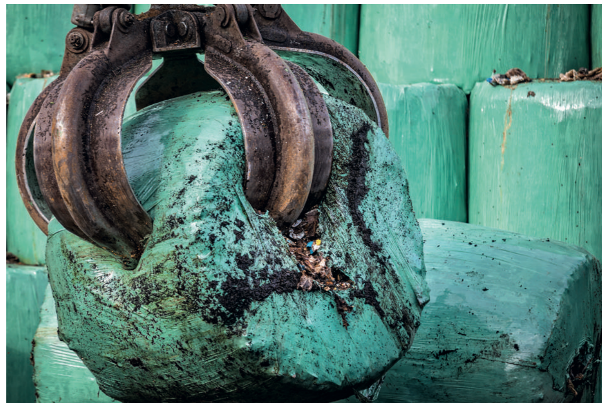
Chargement des déchets mis en balle en vue de leur valorisation thermique
